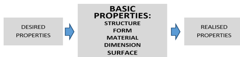
Gambar 1. Lima Ciri Dasar Objek Desain Produk Secara Kasat Mata (Dibuat Ulang Dari Buku 'A Short Course In Industrial Design') [3].
